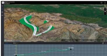
CADソフトの操作スキルが無くても、3D点群データ上で、直接クリックしていくだけで、誰でも簡単に工事用仮設道路などの3Dモデルの作図可能
